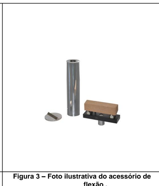
Figura 3 – Foto ilustrativa do acessório de flexão .
